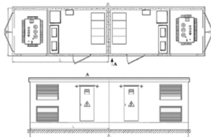
**2КТПБ: параллельная стыковка блоков**
