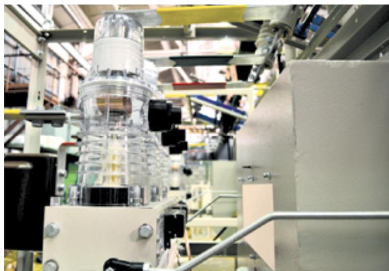
В камерах КСО реализуются различные виды защит и автоматики, как на электромеханических реле, так и на современных микропроцессорных блоках. Камеры комплектуются различными видами механических и электромагнитных блокировок, не допускающих ошибочных действий обслуживающего персонала во время проведения оперативных переключений.
